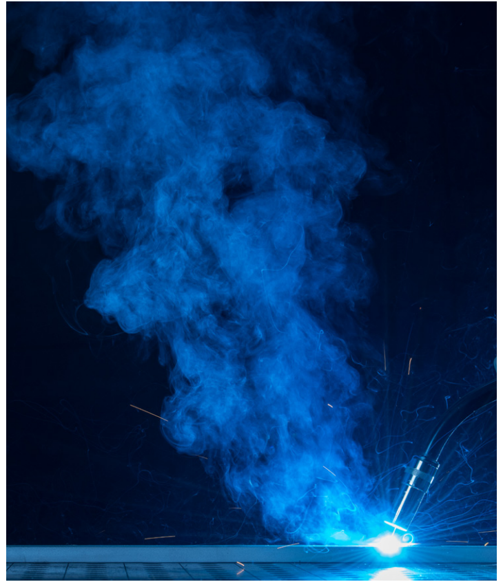
Acier au carbone soudé en procédé GMAW avec du gaz MIG MIX GOLD®
