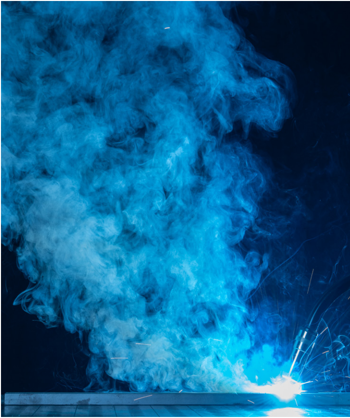
Acier au carbone soudé en procédé GMAW avec du gaz C25
